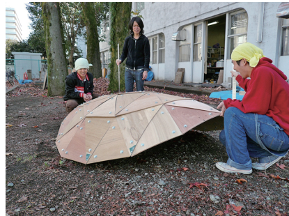
板とボルトからなるシェル構造の体力試験
