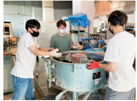
9 モルタルミキサーでコンクリート練り
