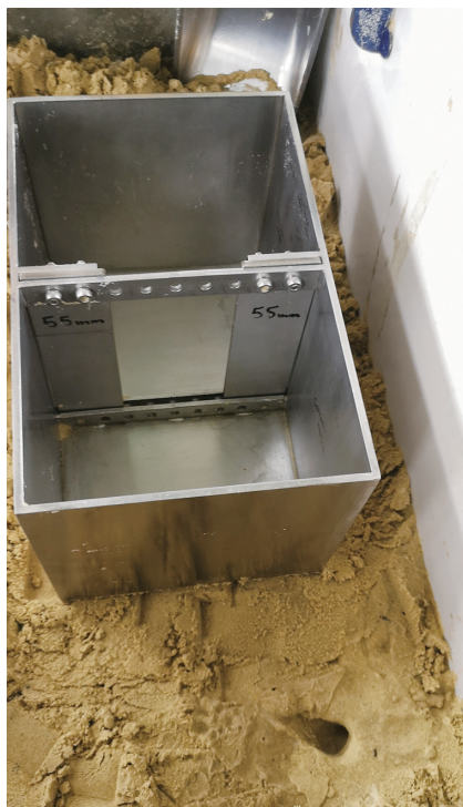
液状化再現装置の中では、鋼矢板の隙間から砂が流出する現象も研究する
