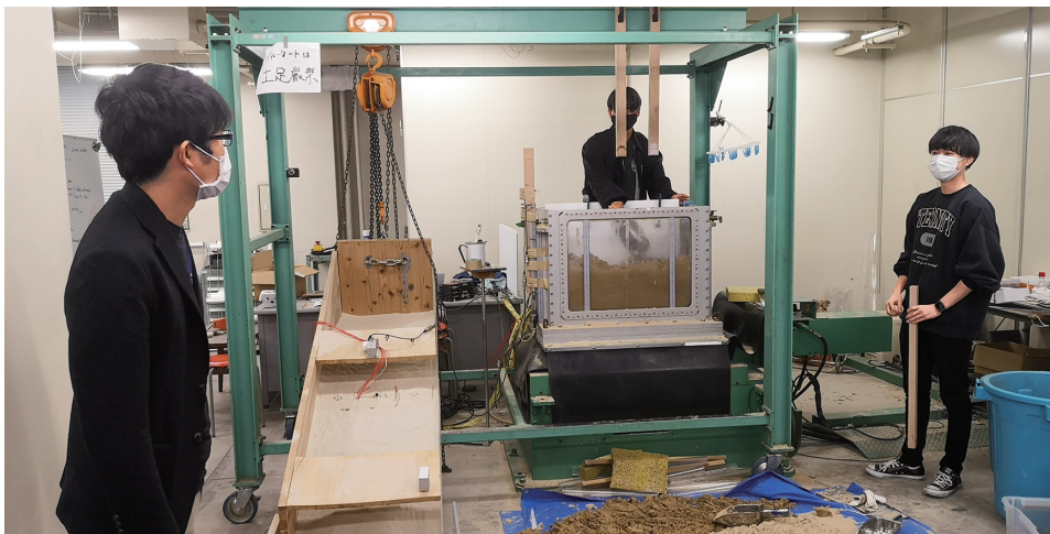
液状化再現装置と模型斜面が設置されている実験室
