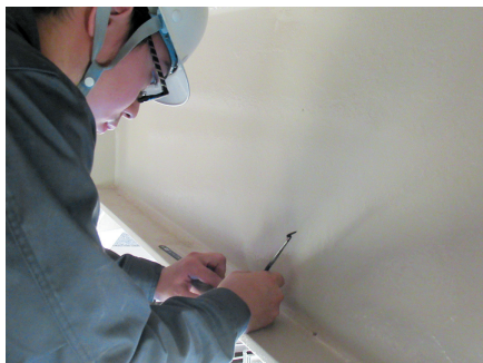
3 体育館へのひずみゲージ貼り付け
